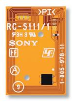
フレキシブルで薄型のFeliCa™ Standard小型アンテナモジュールです。 電子マネーやアクセスコントロールなど、高度なセキュリティーが要求される サービスを多彩な形状で実現できます。また、屈曲耐性のあるフレキシブル 基板により、レザー、布など、柔らかい素材を用いた商品への組み込みが 容易となりました。
