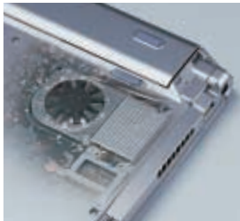
「サーモダイナミクスエアダクト機構」での放熱・排気のイメージ
