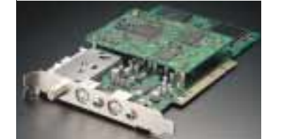
写真上部の基板はDVアナログ変換ハードウェアです。PCV-RX53シリーズには搭載いたしません。
