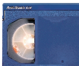
カセット窓にくもりが発生したテープ
