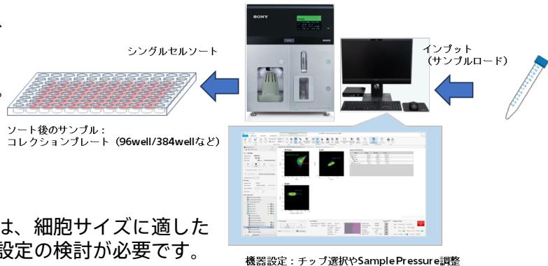
まず、ノズル径の選択についてですが、ソニーのセルソーター(MA900/SH800)では、3種類のチップ(70μm/100μm/130μm)を展開しており、最適なチップを選択することで、生存率の向上が期待できます。これは、シース圧や液滴の落下速度(落下衝撃)などの違いが影響していると考えられます。詳細は以下のアプリケーションシートをご参照ください。
