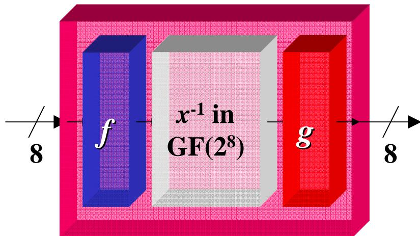
$$\begin{bmatrix} y_0 \\ y_1 \\ y_2 \\ y_3 \\ y_4 \\ y_5 \\ y_6 \\ y_7 \end{bmatrix} = \begin{bmatrix} 00011000 \\ 01010001 \\ 00000001 \\ 00000110 \\ 01100101 \\ 01011100 \\ 01100000 \\ 10000001 \end{bmatrix} \begin{bmatrix} x_0 \\ x_1 \\ x_2 \\ x_3 \\ x_4 \\ x_5 \\ x_6 \\ x_7 \end{bmatrix} + \begin{bmatrix} 0 \\ 0 \\ 0 \\ 1 \\ 1 \\ 1 \\ 1 \\ 0 \end{bmatrix}$$
