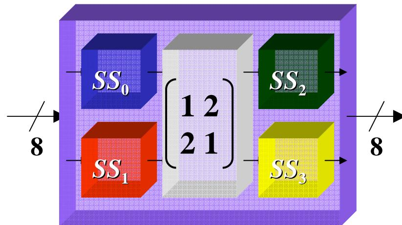
4bit入出力 S-box  $SS_0, SS_1, SS_2, SS_3 \Rightarrow$  自動合成
