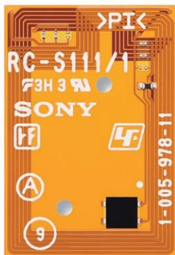
フレキシブルで薄型のFeliCa™ Standard小型アンテナモジュールです。電子マネーやアクセスコントロールなど、高度なセキュリティが要求されるサービスを多彩な形状で実現できます。また、屈曲耐性のあるフレキシブル基板により、レザー、布など、柔らかい素材を用いた商品への組み込みが容易となりました。
