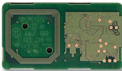
RC-S660/SはUARTに対応し、さまざまな組み込み機器への実装に適したNFCモジュールです。FeliCa™、ISO/IEC 14443 Type A / Type B およびISO/IEC 15693の非接触ICカードまたはICタグと通信が可能です。また、従来製品と同様にアンテナ部とコントロール部を一体化したコンパクトサイズを維持し、多彩な機器へ組み込みやすくなりました。
